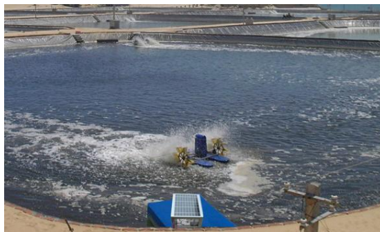
图 6 太阳能供电的氧含量无线监控系统
